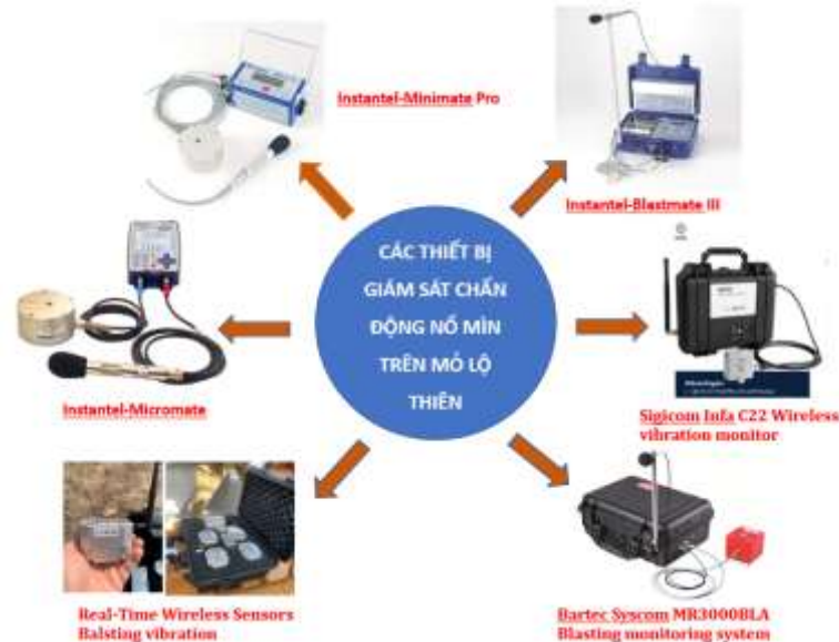
Hình 3.30. Các thiết bị giám sát chấn động nổ mìn hiện đại được sử dụng tại các mỏ lộ thiên [23]
